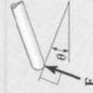
superficie de contacto lisa                                           | Una incógnita. La reacción es una fuerza que actúa perpendicularmente a la superficie en el punto de contacto.                                                                                                                                                    | 1                    |
